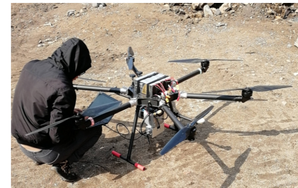
■ Riegl VUX-1LR无人机激光雷达飞行扫描系统
